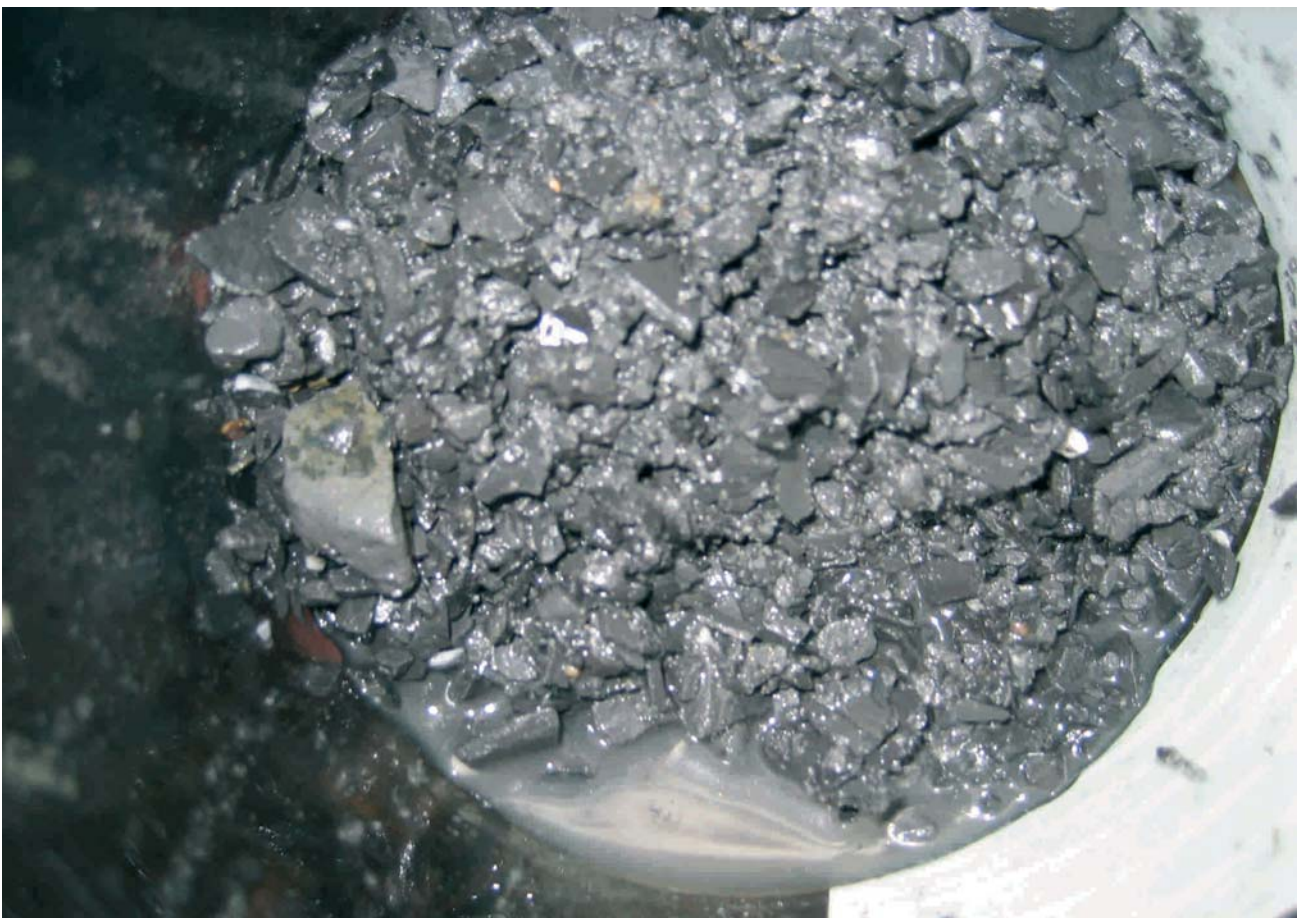
Aufgefangenes Bohrgut zum Bestimmen der Gesteinsschichte – hier Schiefer.
