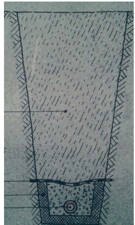
Links Quelle an der Orle: Schnitt der Schürfquelle mit einer Tiefe von 2 bis 3 Meter!
