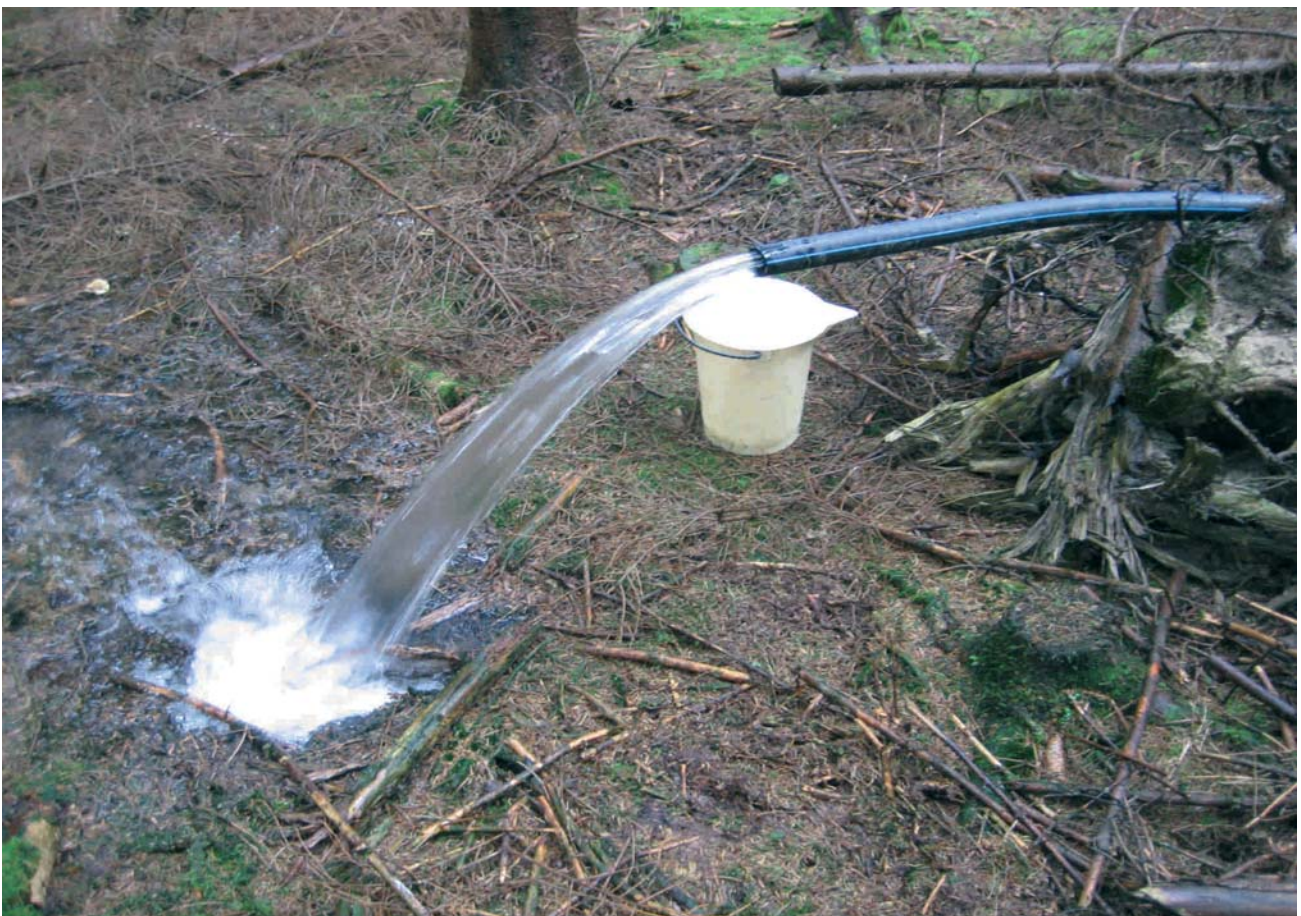
Mehr als 6 cbm in einer Stunde schüttet der Notbrunnen.
